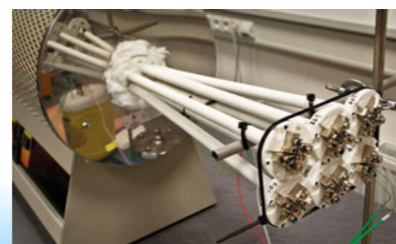
▲ Kalibrace termoelektrických snímačů teploty v kalibrační peci pro vyšší teploty
