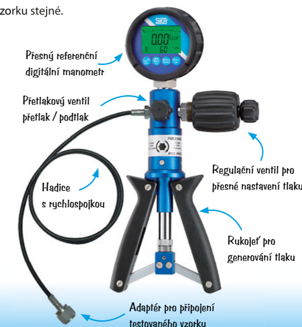
▲ Pneumatiká kalibrační pumpa, model P 60
