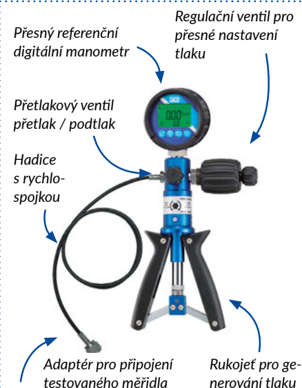
Obr. 4 - Stručný popis částí pneumatické kalibrační pumpy P60
